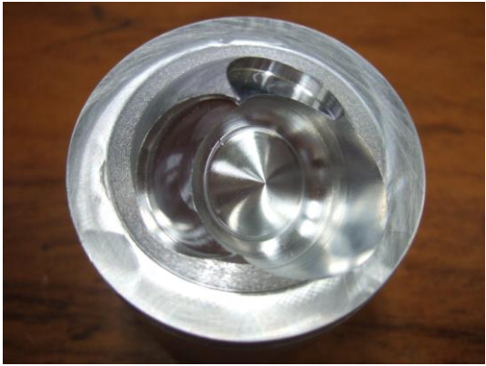
図6 設計・製作したピストン (外観写真)
